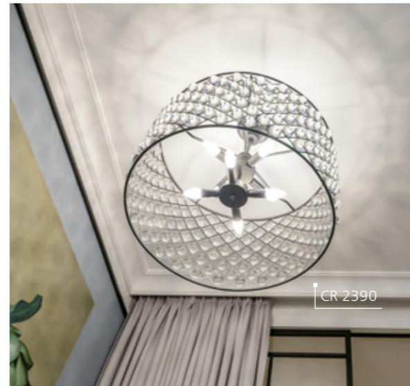
Высокий плинтус Base 5763 повторяет оттенок стен и делает отделку пола завершенной. Потолочный карниз CR 2390 очертил все выступы и короб скрытых коммуникаций, создав рельеф и превратив специфические особенности помещения в достоинства. За потолочным карнизом спрятали крепления для штор.
